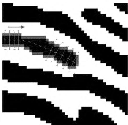
Рисунок F.13 — Расположение контрольной точки окончания остова гребня
