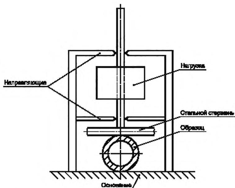
Рисунок 8 — Стенд испытаний на сопротивление высокой температуре
