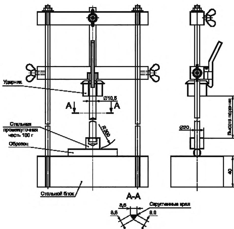
Примечание — Данный рисунок не предназначен для разработки конструкции, за исключением размеров.
