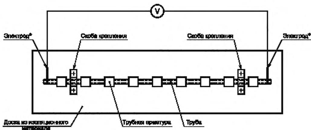
\*Покрытие должно быть удалено, чтобы обеспечить электрический контакт с электродом
