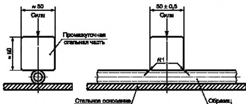
Рисунок 1 — Установка для испытаний на сжатие
