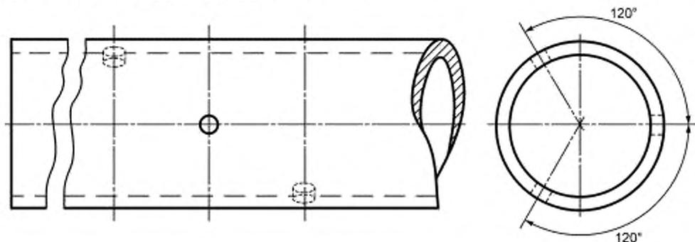
Рисунок Г.1 — Эталонный образец с тремя отверстиями
