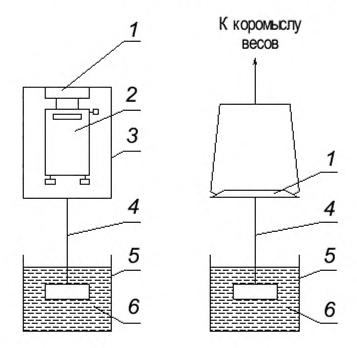
а – с использованием весов без нижнего подвеса; б – с использованием коромысловых весов;
