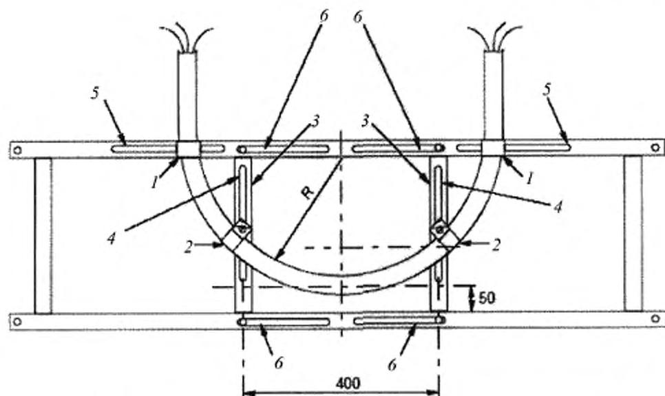
1 — U-образный хомут; 2 — P-образный хомут; 3 — регулируемые вертикальные элементы; 4 — прорезь для фиксации P-образного хомута; 5 — прорезь для фиксации U-образного хомута; 6 — прорезь для перемещения регулируемых вертикальных элементов; R — минимальный радиус изгиба кабеля
