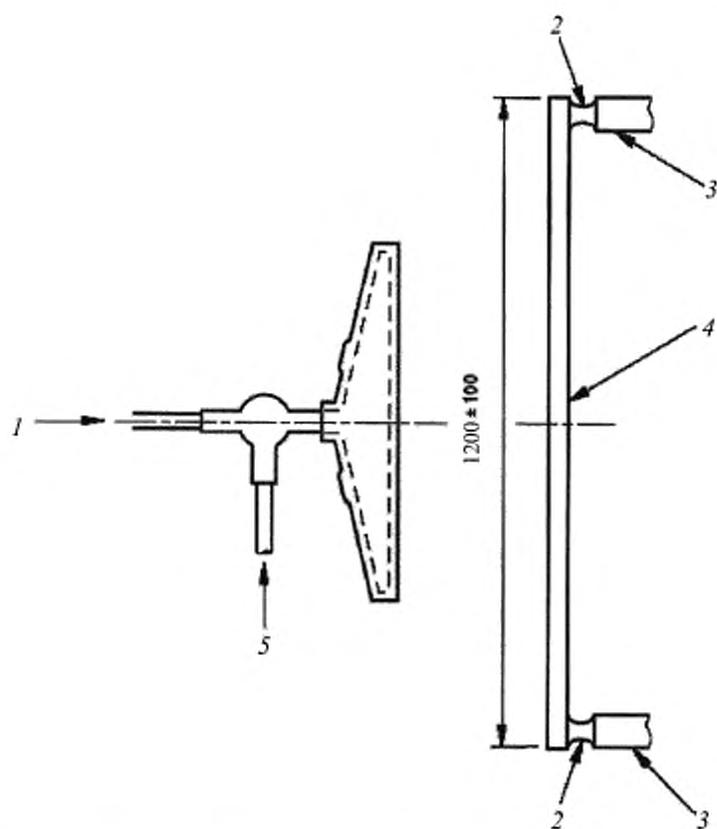
1 — подача воздуха; 2 — резиновая втулка; 3 — жесткая опора; 4 — горизонтальный стальной элемент испытательной лестницы; 5 — подача пропана
