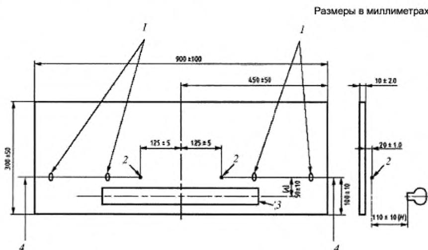
1 — опоры для термопар; 2 — кончик термопары; 3 — горелка; 4 — термопара типа К;  $H$  — расстояние до кончика термопары от фронтальной поверхности горелки по горизонтали;  $V$  — расстояние до кончика термопары от осевой линии горелки по вертикали
