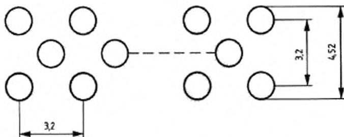
Рисунок 5 — Фронтальная поверхность рабочей части горелки
