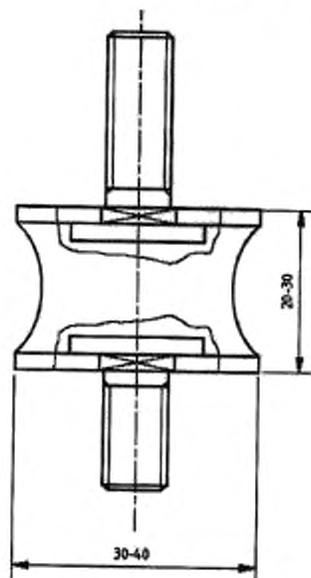
Рисунок 4 — Типичная резиновая втулка для крепления испытательной лестницы
