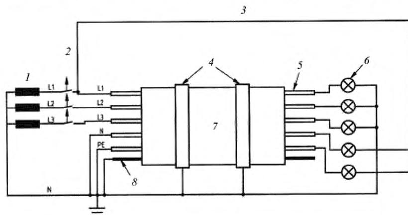
7 — трансформатор; 2 — плавкий предохранитель (2 А); 3 — фазы L1, L2 или L3; 4 — металлические зажимы; 5 — испытуемая жила или группа жил; 6 — нагрузочный индикаторный прибор; 7 — образец; 8 — металлический экран (при наличии); L1, L2, L3 — фазные жилы (L2, L3 — при наличии); N — нейтральная жила (при наличии); PE — защитная жила (при наличии)
