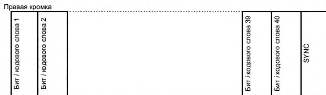
Рисунок 9 – Структура кадра номер *i* для секторов с максимальным перемежением
