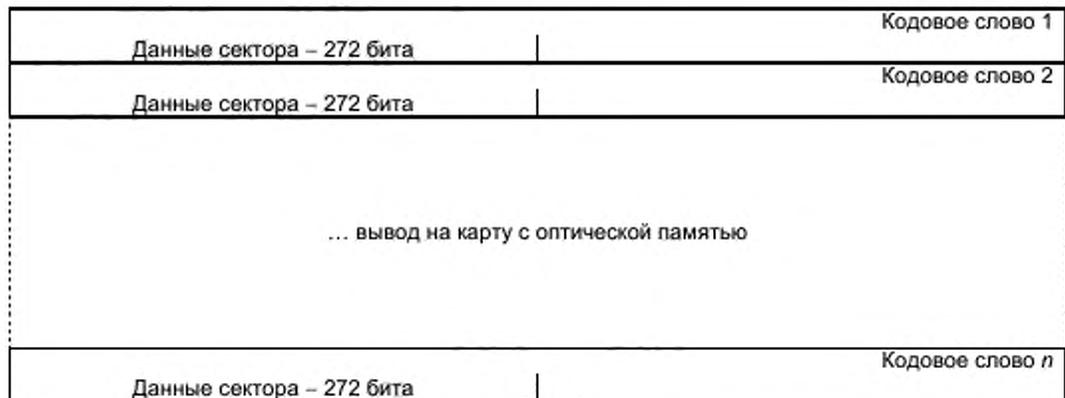
Рисунок 14 – Перемежение данных сектора, сектор типа 5
