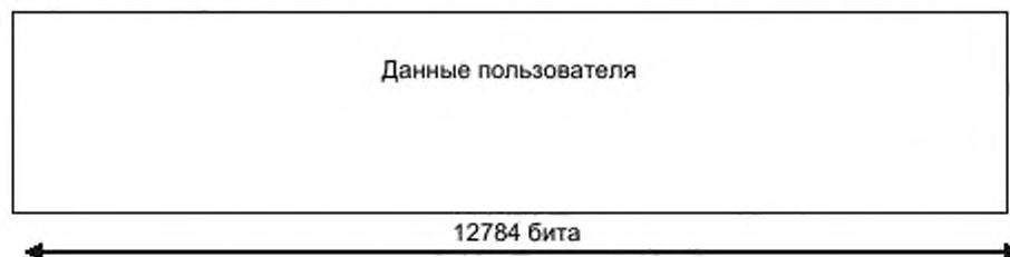
Рисунок 11 – Структура блока данных сектора типа 5
