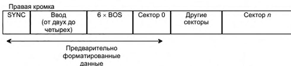
Рисунок 6 – Структура дорожки с неполной записью, секторы типов 0 – 5
