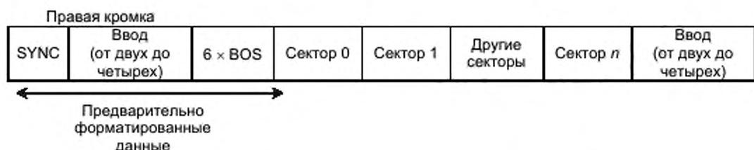
Рисунок 5 – Структура полной дорожки, секторы типов 0 – 5
