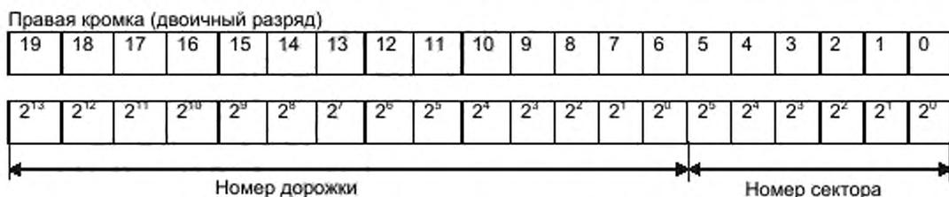
Рисунок 4 – Формат адреса сектора и дорожки
