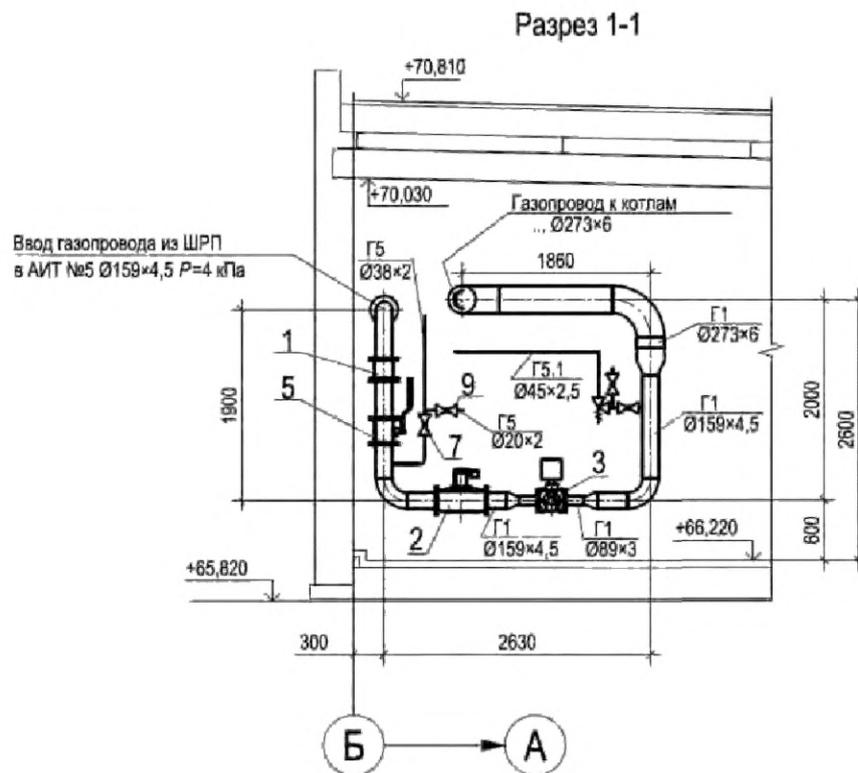
Рисунок В.2 — Пример выполнения разреза для котельной
