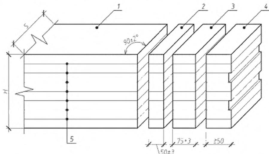
$H$  и  $S$  — высота и ширина клеевого элемента; 1 — многослойный элемент, 2 — заготовка для выпиливки образцов для предварительных испытаний на послойное скалывание; 3 — образец для испытаний на расслаивание; 4 — торцевой срез; 5 — клеевые швы
