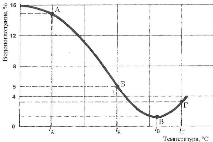
$t_A$  – температура начала спекания;  $t_B$  – температура, при которой получают черепок с  $W = 5\%$ ;  $t_{\text{min}}$  – температура, при которой получают черепок с наименьшим водопоглощением;  $t_Г$  – температура, при которой отмечают признаки пережога образцов (деформация, вспучивание, появление блеска, начало снижения кажущейся плотности)
