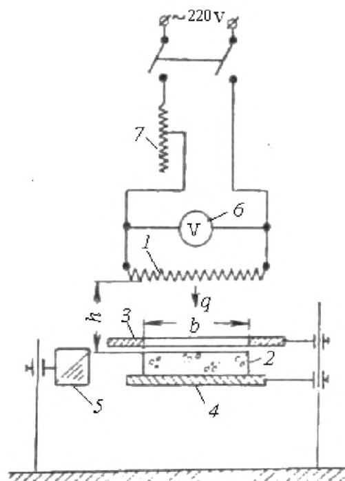
$b$  – размер отверстия экрана;  $q$  – тепловой поток;
