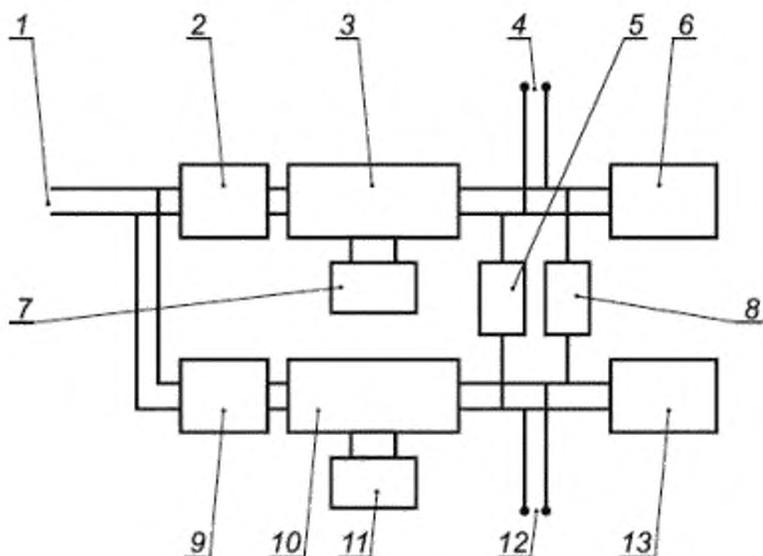
1 – электрическая сеть; 2 – дополнительный фильтр; 3 – эквивалент сети А по CISPR 16-1-2; 4 – порт В; 5 – дроссель индуктивностью 660 мкГн; 6 – имитатор оборудования связи; 7 – резистор сопротивлением 50 Ом; 8 – дроссель индуктивностью 660 мкГн; 9 – дополнительный фильтр; 10 – эквивалент сети В по CISPR 16-1-2; 11 – резистор сопротивлением 50 Ом; 12 – порт А; 13 – испытуемое оборудование
