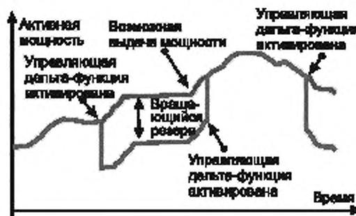
Рисунок В.4 – Схематическое изображение управляющей дельта-функции мощности
