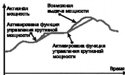
Рисунок В.3 – Схематическое изображение функции градиента регулирования мощности
