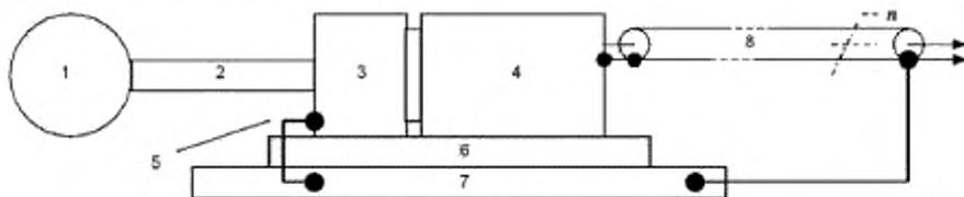
1 — рабочая среда; 2 — трубка; 3 — адаптер давления; 4 — датчик давления; 5 — заземление;
