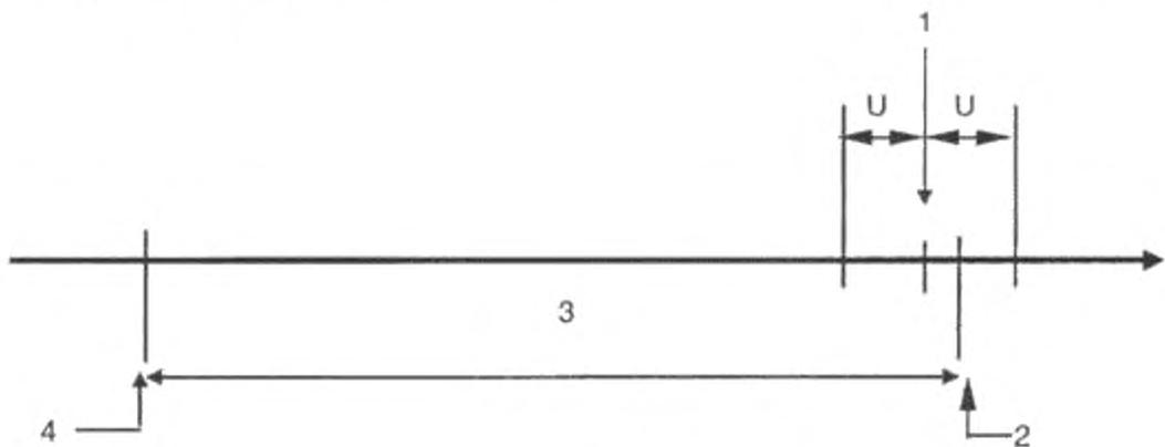
1 – результат измерения; 2 – верхний допустимый предел (USL); 3 – диапазон спецификации; 4 – нижний допустимый предел (LSL)
