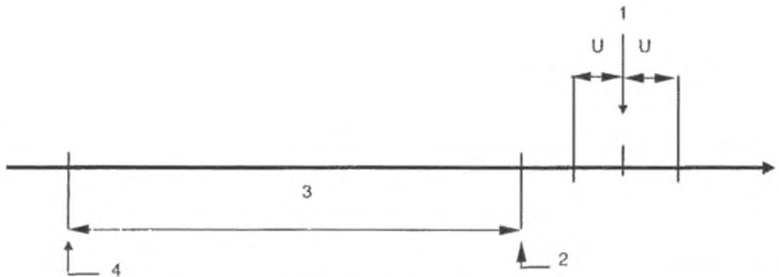
1 – результат измерения; 2 – верхний допустимый предел (USL); 3 – диапазон спецификации; 4 – нижний допустимый предел (LSL)
