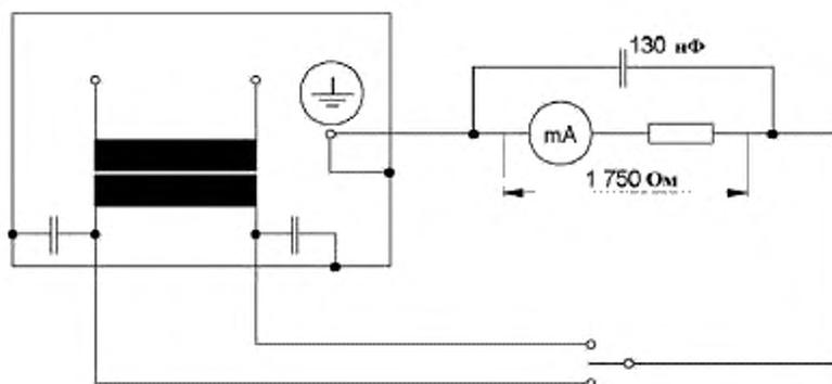
Примечание — Для оборудования класса II используется РЕ-терминал заземленной сети питания.
