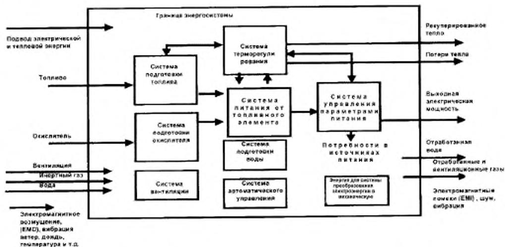
Рисунок 1 — Компоненты энергоустановки на топливных элементах
