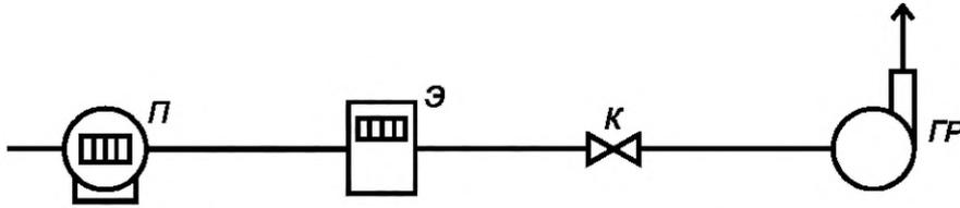
Рисунок А.3 — Поверочная установка с эталонным счетчиком газа
