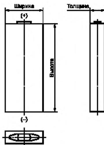
Рисунок 4 — Малогабаритный призматический аккумулятор в чехле
