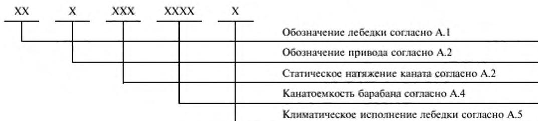
A.6 Пример условного обозначения лебедки с электрическим приводом со статическим натяжением каната на первом слое навивки 100 кН, с канатоемкостью барабана 1500 м для умеренного климата:
