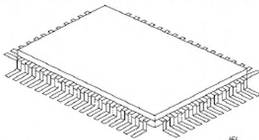
Рисунок 5 – Конструкция корпуса типа PQFP (прямоугольный)
