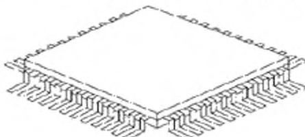
Рисунок 17 – Конструкция корпуса типа PTQFP (квадратного)
