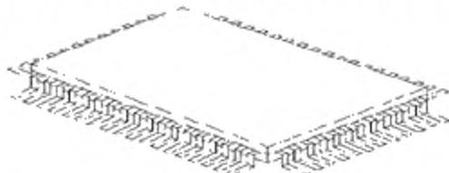
Рисунок 13 – Конструкция корпуса типа PLQFP (прямоугольный)
