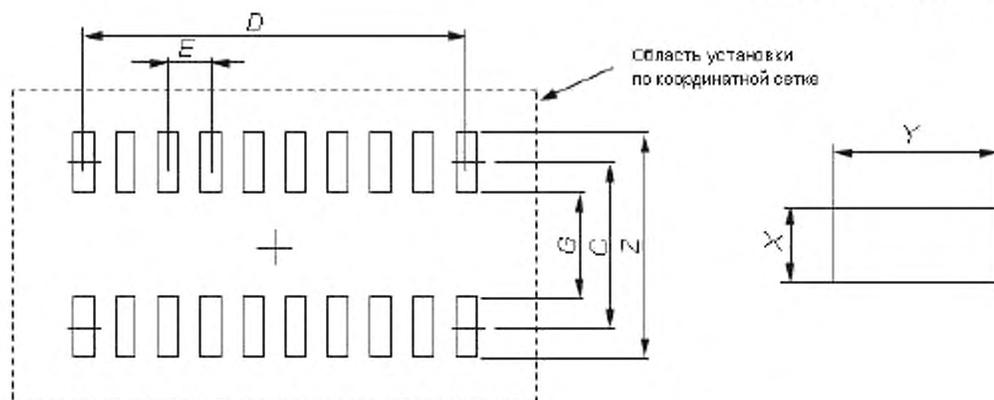
Рисунок 4 – Размеры посадочного места корпуса SOJ, лист 1
