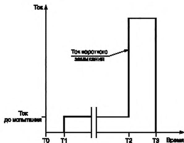
T0 — размыкание короткозамыкателя [перечисление а) 9.3.4.1.6]; T1 — подача питания в испытательную цепь [перечисление б) 9.3.4.1.6]; T2 — короткозамыкатель замкнут [перечисление с) 9.3.4.1.6];
