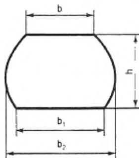
Рисунок 2 — Поперечное сечение бруса вида Б
