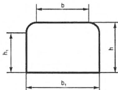
Рисунок 1 — Поперечное сечение бруса вида А
