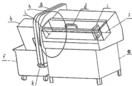
*a* – неподвижный защитный кожух ножа/камера резки; *b* – разгрузочный короб; *c* – толкатель блоков с держателем; *d* – защитная крышка загрузочного лотка; *e* – рама/корпус; *f* – тележка; *g* – загрузочный лоток; *h* – нож и зона его вращения; *i* – зона резки; *k* – накопительный бункер
