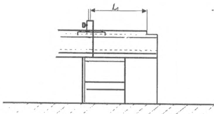
$L_1 \geq 850$  – безопасное расстояние, если загрузочный лоток открыт с противоположной от ножа стороны
