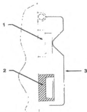
1 – «Выкл.»; 2 – «Вкл.»; 3 – защитный кожух («Выкл.»)
