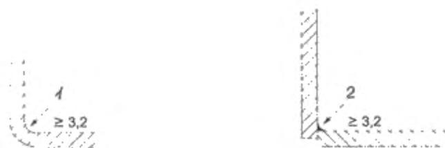
1 – радиус, образованный механической обработкой фасонным резцом
