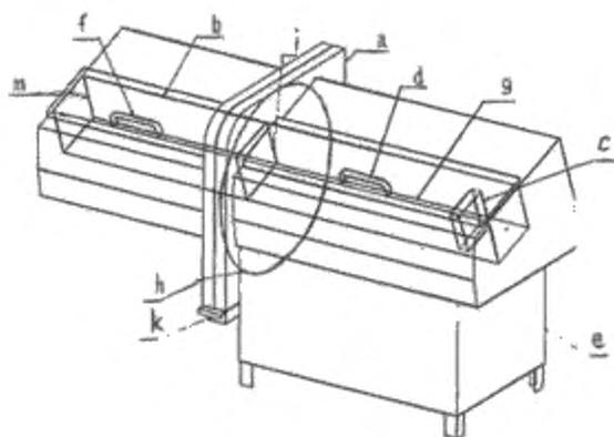
*a* – неподвижный защитный кожух ножа/камера резки; *b* – разгрузочный лоток; *c* – толкатель блоков с держателем; *d* – защитная крышка загрузочного лотка; *e* – рама/корпус; *f* – защитная крышка разгрузочного лотка; *g* – загрузочный лоток; *h* – нож и зона его вращения; *i* – зона резки; *k* – накопительный бункер; *m* – стол разгрузки
