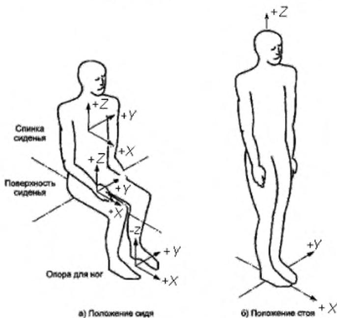
Рисунок 2 — Система координат, связанная с пассажиром
