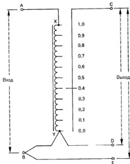
Рисунок 2 — Соединения входа и выхода индуктивного делителя напряжения
