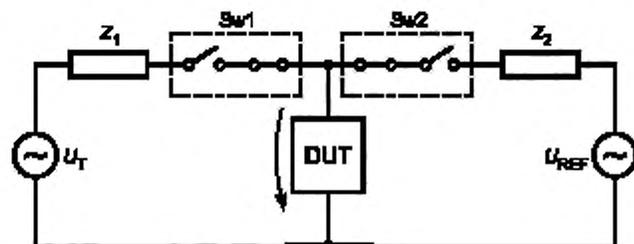
$U_T$  — ВПН по приложению В;  $U_{REF}$  — контрольное испытательное напряжение по приложению А;  $Z_1$  — полное сопротивление для регулирования ожидаемого тока короткого замыкания  $U_T$ ;  $Z_2$  — полное сопротивление для регулирования ожидаемого тока короткого замыкания  $U_{REF}$ . Sw1 — выключатель для подачи ВПН к УЗИП; Sw2 — выключатель для подачи контрольного испытательного напряжения к УЗИП; DUT — испытуемое устройство (УЗИП + разъединитель, при наличии)
