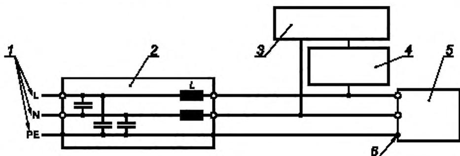
Рисунок 2 — Пример развязывающего фильтра для однофазной сети
