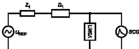
$Z_1$  — полное сопротивление для регулирования ожидаемого тока короткого замыкания согласно таблице 8;
