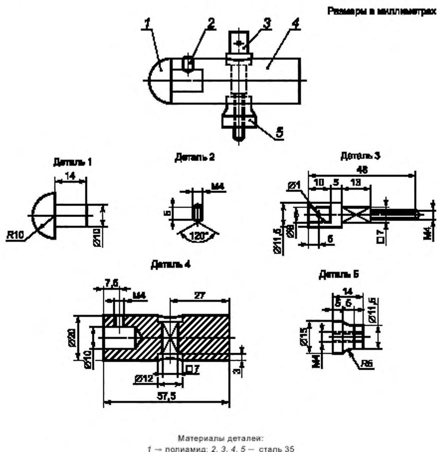
Рисунок 19 — Ударный элемент маятникового молотка для нанесения удара
