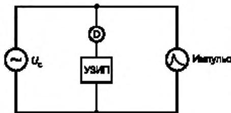
$U_c$  — источник питания промышленной частоты по 8.3.4.2; D — разъединители УЗИП, указанные изготовителем; импульс: ток 8/20 для испытаний класса I и II в рабочем режиме по 8.3.4.3; импульсный ток  $I_{imp}$  для испытания в дополнительном режиме по 8.3.4.4; комбинированная волна для испытаний класса III в рабочем режиме по 8.3.4.5
