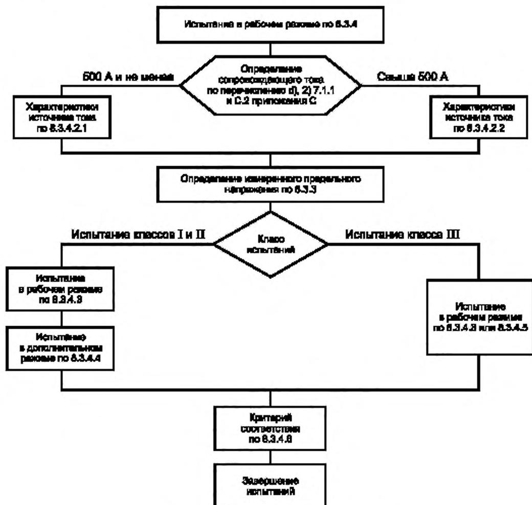
Рисунок 6 — Схема испытания в рабочем режиме
