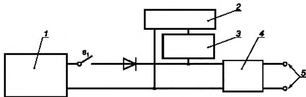
1 — генератор постоянного тока  $U_c \sqrt{2}$  — для переменного тока,  $U_c$  — для постоянного тока,
