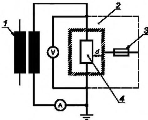
1 — источник тока промышленной частоты; 2 — металлический экран; 3 — предохранитель на 6 А; 4 — УЗИП;
