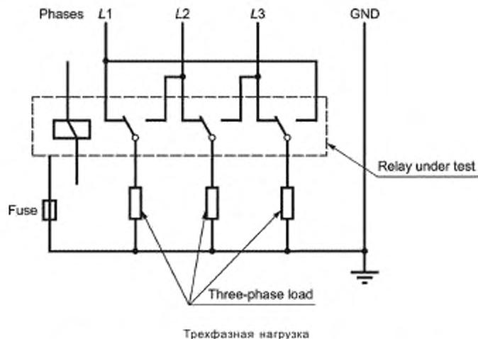
Рисунок 10 — Тестовая схема для переноса нагрузки
