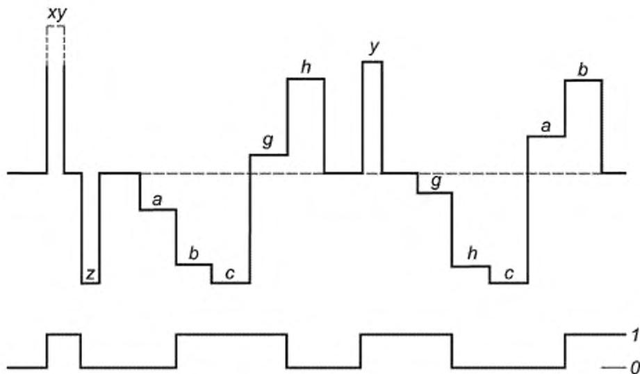
*a* — нерабочее напряжение; *b* — рабочее напряжение; *c* — номинальное напряжение; *g* — напряжение возврата в исходное положение (бистабильные реле); *h* — напряжение отпущения (моностабильное реле); *x* — напряжение предварительного условия; *y* — рабочее (установочное) напряжение; *z* — рабочее (установочное) напряжение реверса
