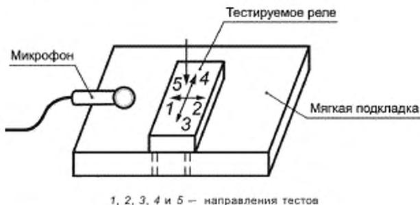
Рисунок 14 — Установка для теста излучения акустических шумов
