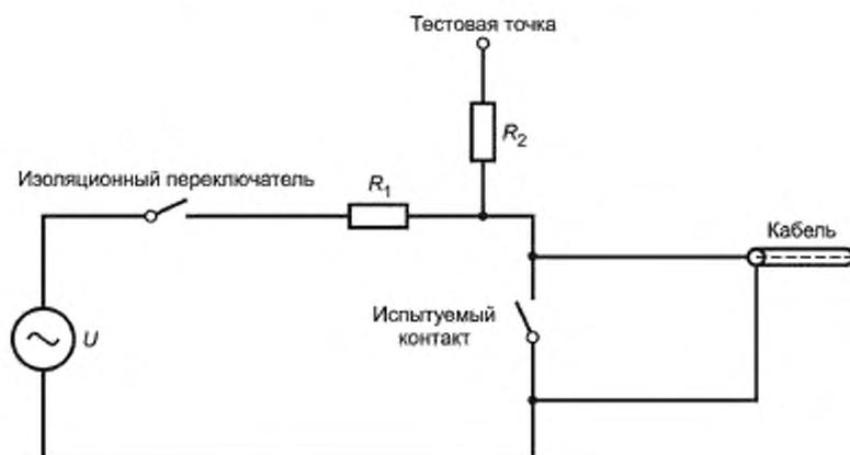
Рисунок С.3 — Цепь нагрузки
