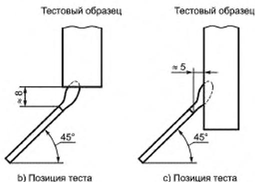
Рисунок В.3 — Детали испытания игольчатым пламенем
