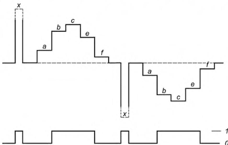
*a* — нерабочее напряжение; *b* — рабочее напряжение; *c* — номинальное напряжение, *e* — напряжение неотпускания (моностабильное реле); *f* — напряжение отпускания (моностабильное реле); *x* — напряжение предварительного условия
