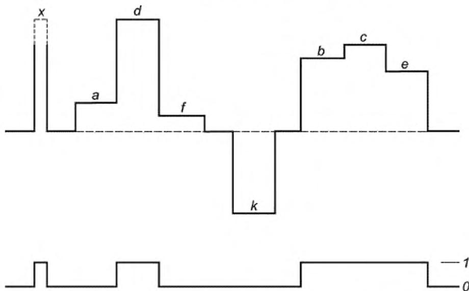
*a* — нерабочее напряжение; *b* — рабочее напряжение; *c* — номинальное напряжение; *d* — напряжения невзврата в исходное положение; *e* — напряжение неотпускания (моностабильное реле); *f* — напряжение отпущения (моностабильное реле); *k* — напряжение реверса полярности; *x* — напряжение предварительного условия
