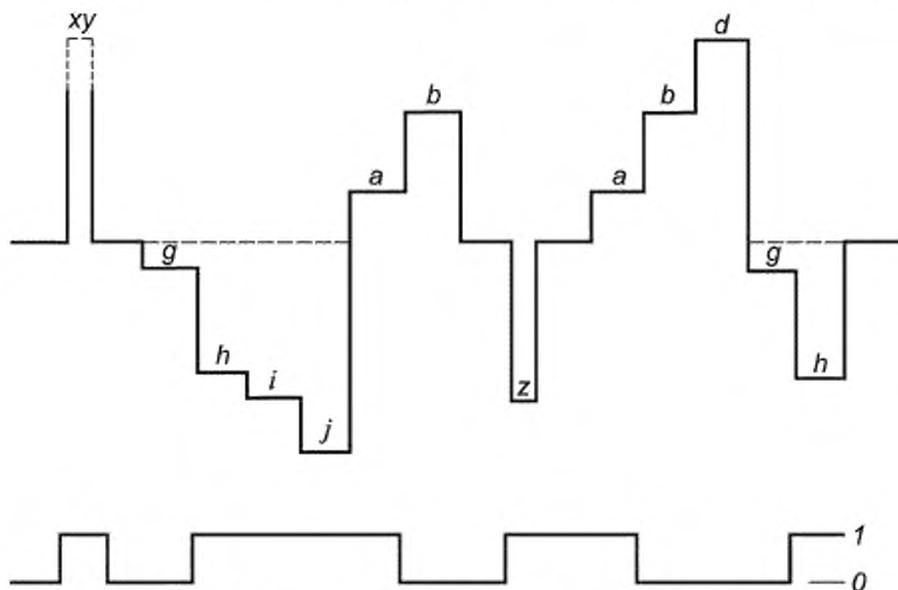
*a* — нерабочее напряжение; *b* — рабочее напряжение; *d* — напряжение возврата в исходное положение; *g* — напряжение неотпущения (бистабильные реле); *h* — напряжение отпущения (бистабильные реле); *i* — номинальное напряжение реверса; *j* — напряжение реверса без возврата в исходное положение; *x* — напряжение предварительного условия; *y* — рабочее (установочное) напряжение; *z* — рабочее (установочное) напряжение реверса
