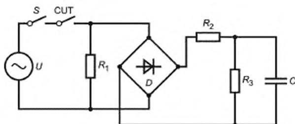
$R_1 = UI$ , где  $U$  — номинальное напряжение и  $I$  — установившийся ток нагрузки;  $R_2 = R_1 \cdot 1,414/(X - 1)$ , где  $X$  — отношение между пиковым пусковым током и установившимся током;  $R_3 = (800/X) \cdot R_1$ ,  $C \cdot R_2 = = 2\,500$  мкс — стандартное значение для нагрузки лампой; допустимы другие величины;  $D$  — мост-выпрямитель;  $S$  — изоляционный переключатель;  $CUT$  — испытуемый контакт.
