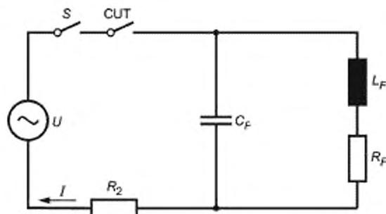
CUT — испытуемый контакт; S — выключатель-разъединитель;  $C_F = 70 \text{ мкФ} \pm 10\%$  ( $I \leq 6 \text{ А}$ ), где  $I$  — установившийся ток,  $C_F = 140 \text{ мкФ} \pm 10\%$  ( $6 \text{ А} < I \leq 20 \text{ А}$ ), где  $I$  — установившийся ток, если производителем не установлено иное.
