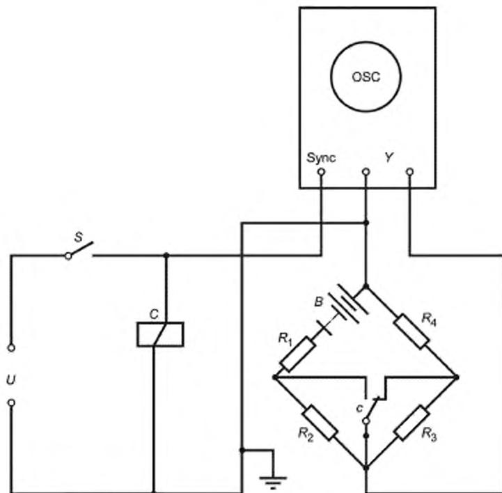
$C$  — катушка реле;  $c$  — контакт реле;  $U$  — источник питания возбуждения;  $S$  — переключатель, свободный от дребезга контактов;  $B$  — батарея.  $R_1$ — $R_4$  — резисторы; OSC — осциллограф, Sync — вход триггера; Y — вход вертикального отклонения
