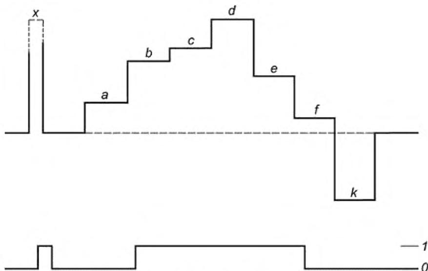
*a* — нерабочее напряжение; *b* — рабочее напряжение; *c* — номинальное напряжение; *d* — напряжения невзврата в исходное положение; *e* — напряжение неотпускания (моностабильное реле); *f* — напряжение отпущения (моностабильное реле); *k* — напряжение реверса полярности; *x* — напряжение предварительного условия
