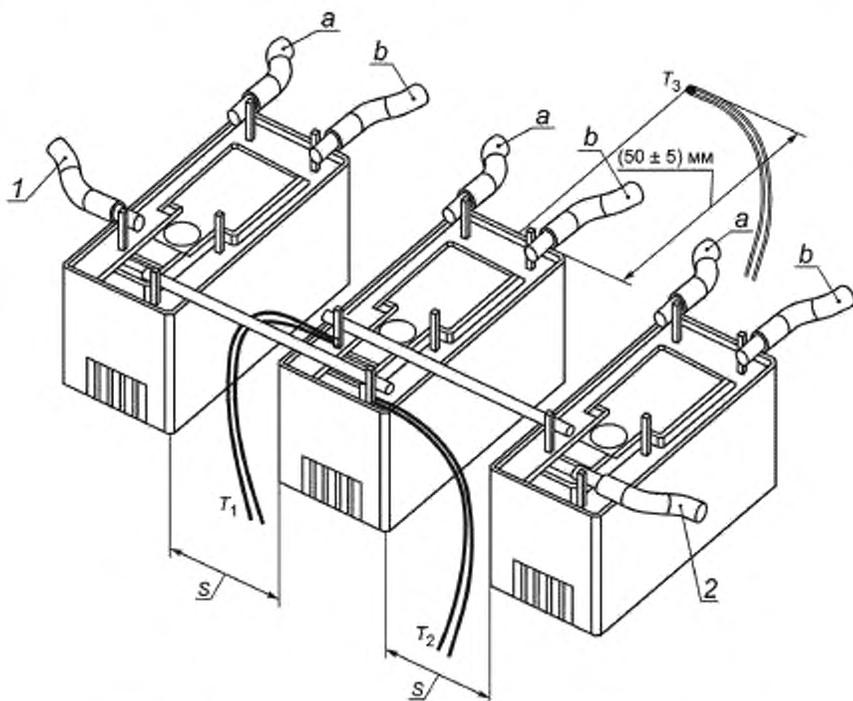
1, 2 — клеммы контактов;  $T_1$ ,  $T_2$ ,  $T_3$  — термодатчики; a, b — клеммы катушек,
