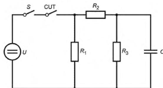
$R_1 = U/I$ , где  $U$  — номинальное напряжение и  $I$  — установившийся ток нагрузки;  $R_2 = R_1 \cdot I/(X - 1)$ , где  $X$  — отношение между пиковым пусковым током и установившимся током;  $R_3 = (800/X) \cdot R_1$ .  $C \cdot R_2 = 2500 \text{ мкс}$  — стандартное значение для нагрузки лампой; допустимы другие величины;  $CUT$  — испытуемый контакт;  $S$  — изоляционный переключатель.
