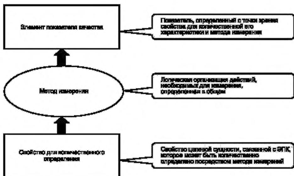
Рисунок 4 — Взаимосвязь между свойством количественного определения, метода измерения и ЭПК
