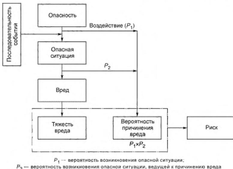
Рисунок 1 — Схема взаимосвязи между опасностью, последовательностью событий, опасной ситуацией и вредом
