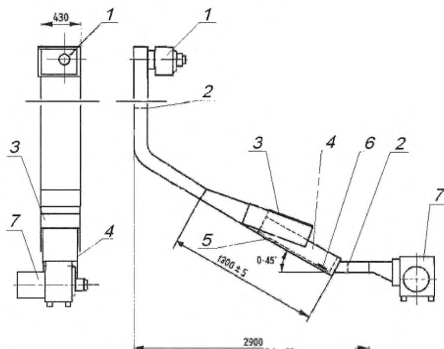
1 — вентиляционный насос системы удаления продуктов сгорания; 2 — заслонка; 3 — покрытие камеры сжигания со смотровым люком; 4 — камера сжигания; 5 — образец для испытания; 6 — деревянный штабель; 7 — вентилятор системы подачи воздуха
