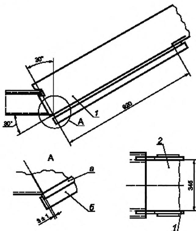
1 — стенки камеры сгибания; 2 — образец для испытания;
