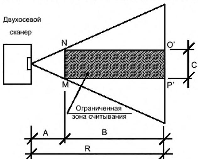
Рисунок 3 – Пример ограниченной зоны считывания (зона MNO'P')
