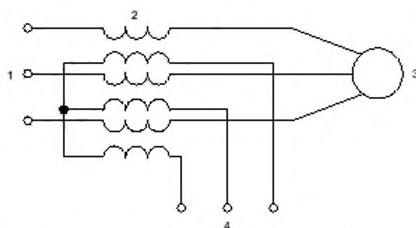
1 – основной генератор; 2 – последовательный трансформатор; 3 – вспомогательный генератор;
