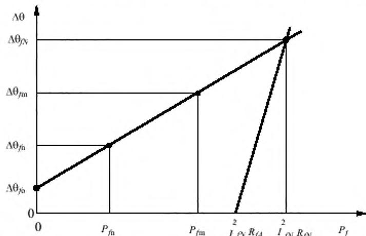
$I_m$  – номинальный ток обмотки возбуждения;  $R_{jA}$  – сопротивление обмотки возбуждения при стандартной температуре;  $R_{jN}$  – сопротивление обмотки возбуждения при расчетной нагрузке
