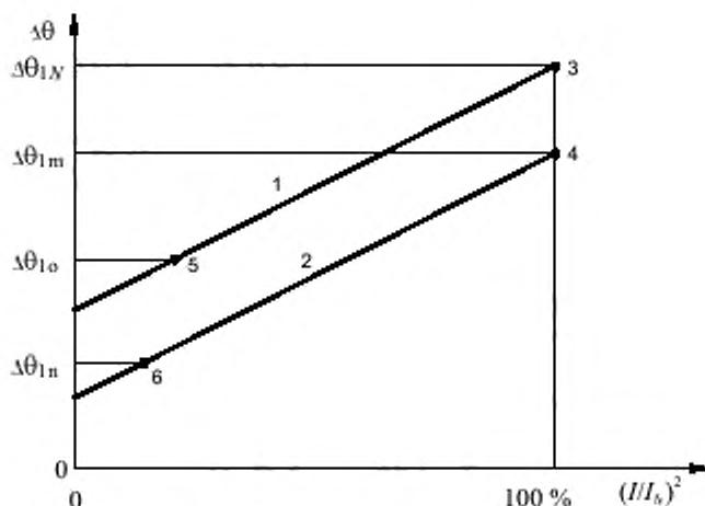
1 – кривая для номинального напряжения; 2 – кривая для пониженного напряжения;
