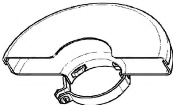
Рисунок 102б — Пример б) защитного кожуха
