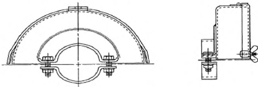
Рисунок 102а — Пример а) защитного кожуха
