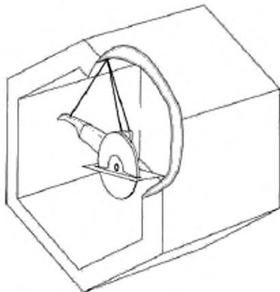
Рисунок 106 — Камера для испытания кожуха на прочность
