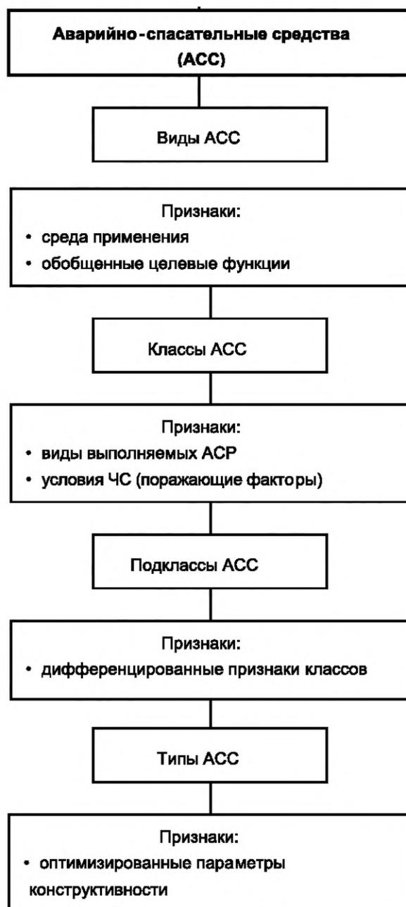
Рисунок 1 — Предметно-признаковая схема классификации аварийно-спасательных средств
