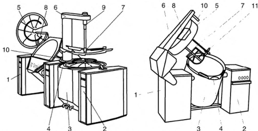
б) Два связанных друг с другом котла и работающие котлы, с верхним приводом мешалки, которая может совершать вращения между котлами
