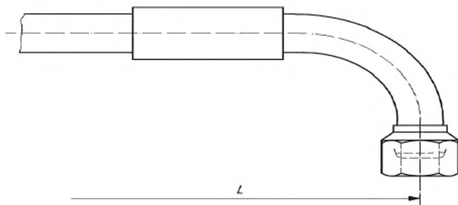
Рисунок 7 — Длина от средней линии nipples (угол 90°) для присоединения рукава
