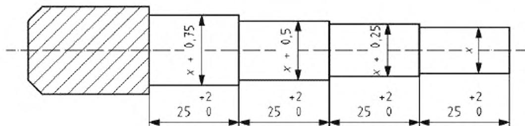
Рисунок 1 — Калибры-пробки
