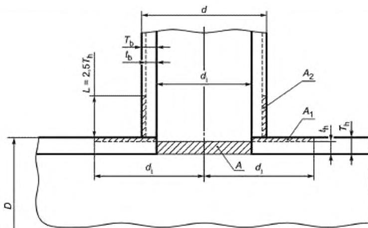
Рисунок Б.1 — Схема для расчета сварного тройника
