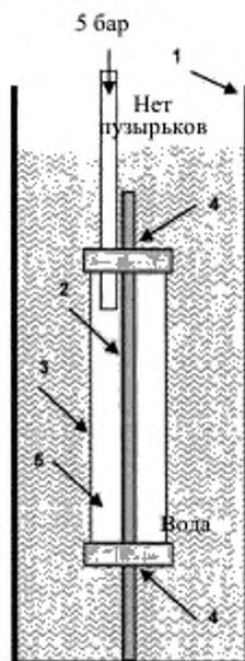
1 – бак, наполненный водой; 2 – заземляющий электрод; 3 – устройство уплотнения заземляющего электрода; 4 – уплотнители; 5 – воздух
