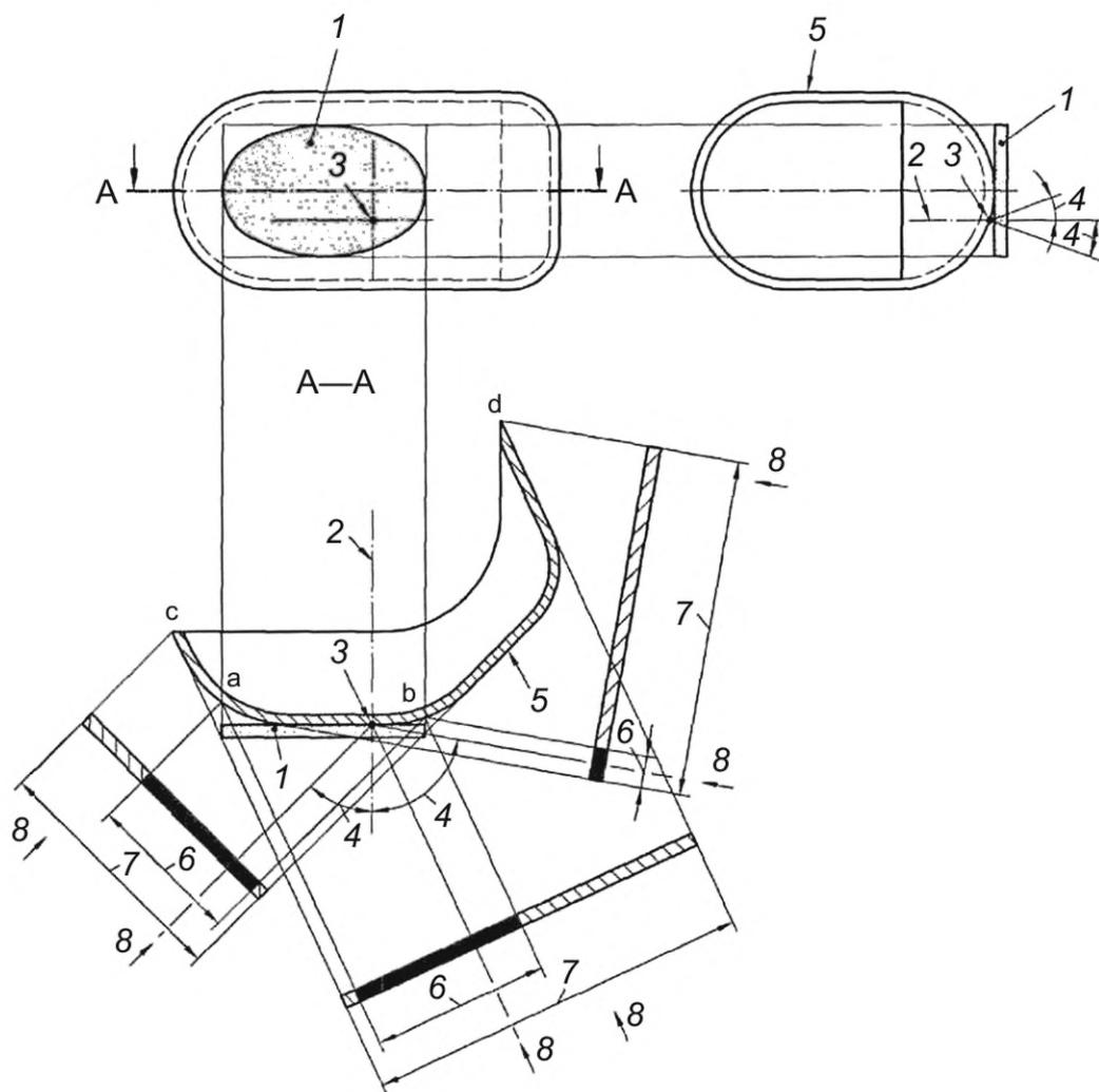
1 — освещающая поверхность; 2 — ось отсчета; 3 — центр отсчета; 4 — угол геометрической видимости; 5 — светоизлучающая поверхность; 6 — кажущаяся поверхность, основанная на освещающей поверхности; 7 — кажущаяся поверхность, основанная на светоизлучающей поверхности; 8 — направление видимости
