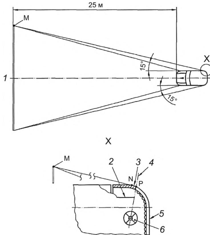
1 — зона 1; 2 — непрозрачная поверхность или деталь; 3 — прозрачная линза (не являющаяся частью светоизлучающей поверхности); 4 — граница светоизлучающей поверхности; 5 — светоизлучающая поверхность; 6 — нить накала лампы
