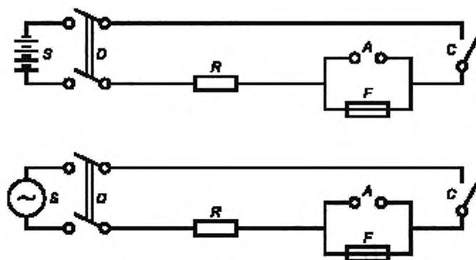
A — съемная вставка, используемая для калибровки; C — контактор, замыкающий цепь; D — выключатель для отключения источника питания; F — испытываемый предохранитель, S — источник питания, полное сопротивление которого составляет менее 10 % общего полного сопротивления цепи; R — последовательно включенный резистор, отрегулированный для получения необходимого ожидаемого тока
