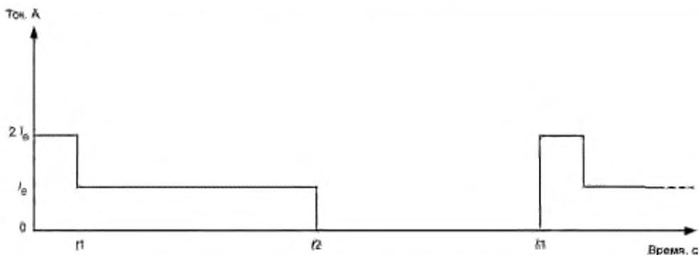
$t_1$  — время скачка тока, равное 10 мс;  $t_2$  — время включения;  $t_3$  —  $t_4$  — время выключения (время выключения, равное времени включения);  $t_3$  — время функционирования, равное 1 с
