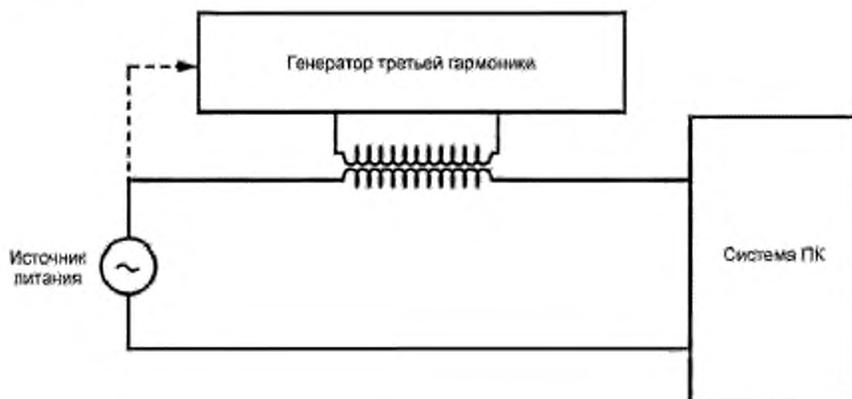
Рисунок 7 — Испытание на устойчивость к напряжению третьей гармоники
