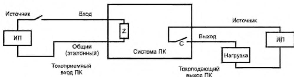
С — выход; механический или статический контакт (например, сухой релейный контакт, симистор, транзистор или аналогичное устройство); Z — вход; входной импеданс; ИП — внешние источники питания
