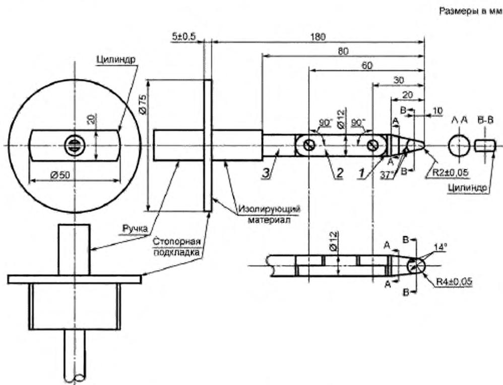
Рисунок С.1 — Шарнирный испытательный палец
