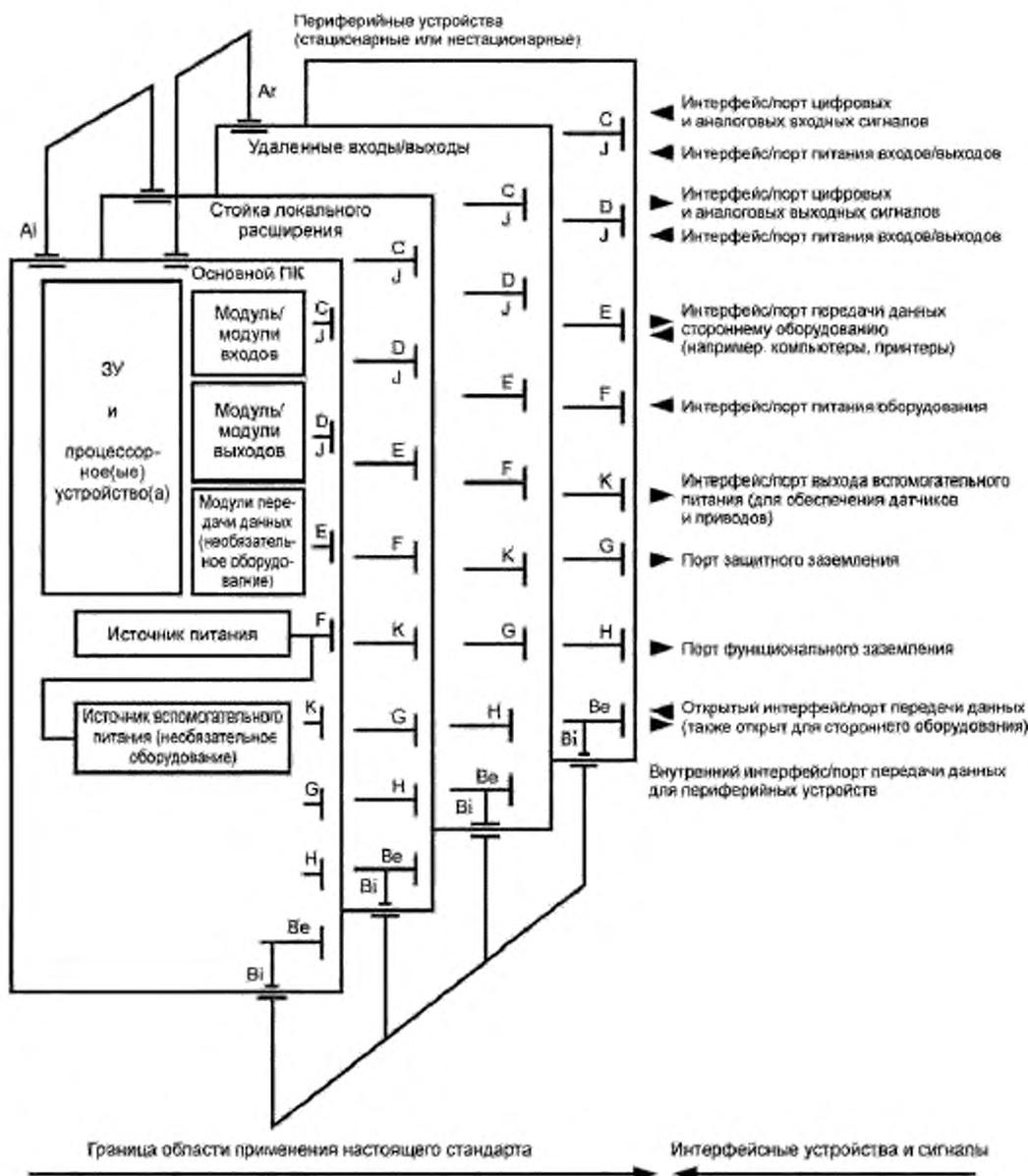
Рисунок 2, лист 1 — Типовая конфигурация интерфейсов/портов системы ПК
