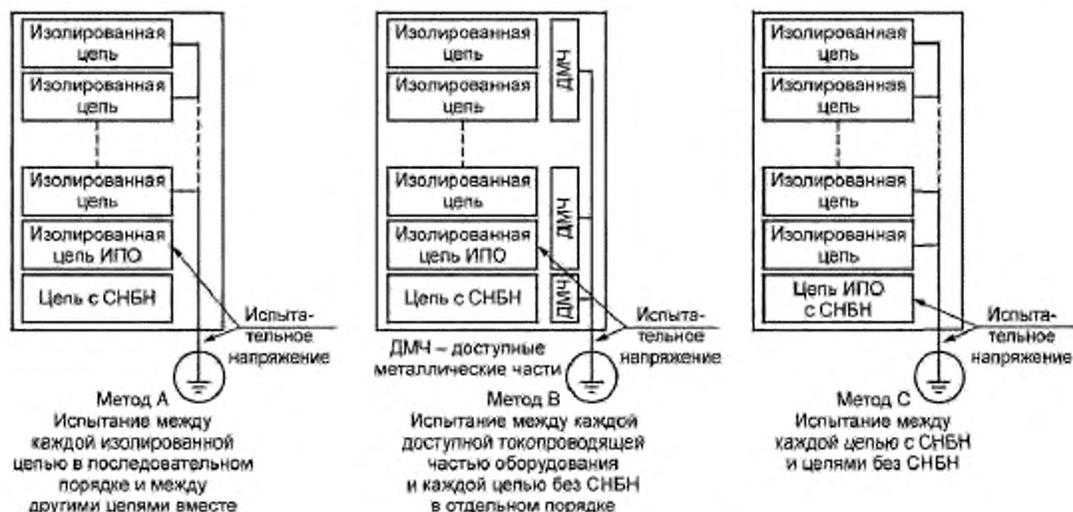
Рисунок 13 — Методы испытания на электрическую прочность диэлектрика
