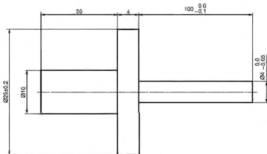
Рисунок С.3 — Испытательный штифт 100 × 4 мм
