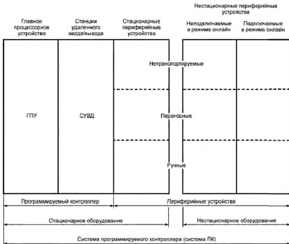
Рисунок А.1 — Система программируемого контроллера (система ПК)
