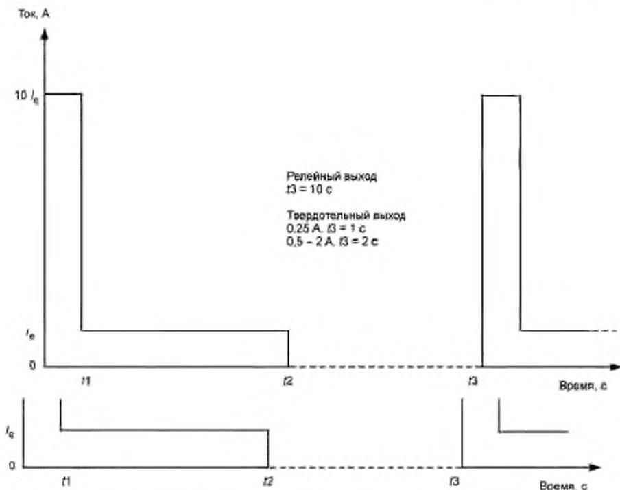
$t_1$  — два цикла при частоте  $F_n$  ( $F_n$  — номинальная частота напряжения сети питания);  $t_2$  — время включения;
