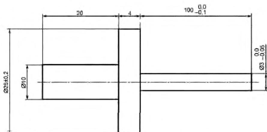
Рисунок С.4 — Испытательный штифт 100 × 3 мм
