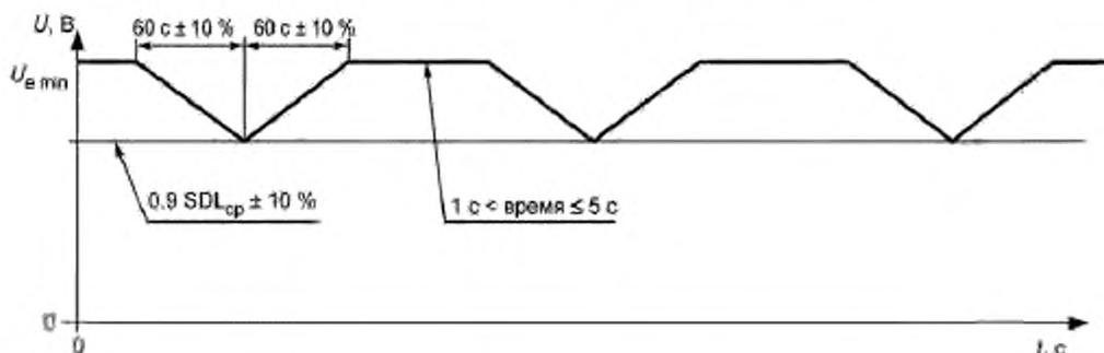
Рисунок 10 — Испытание на медленное изменение напряжения питания
