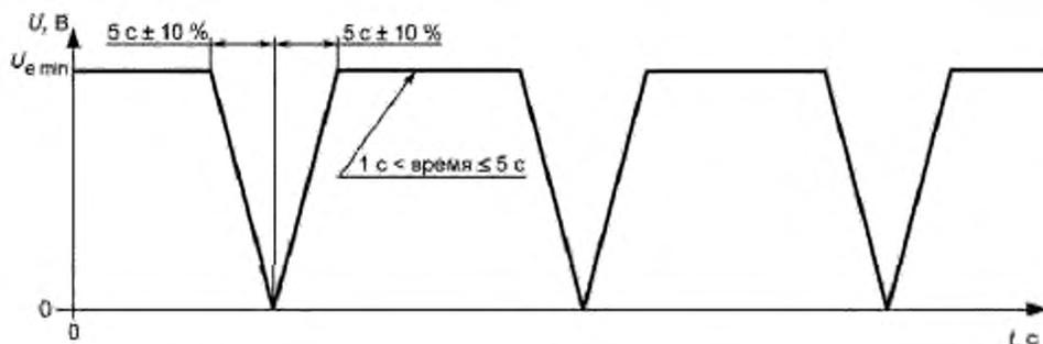
Рисунок 9 — Испытание на быстрое изменение напряжения питания
