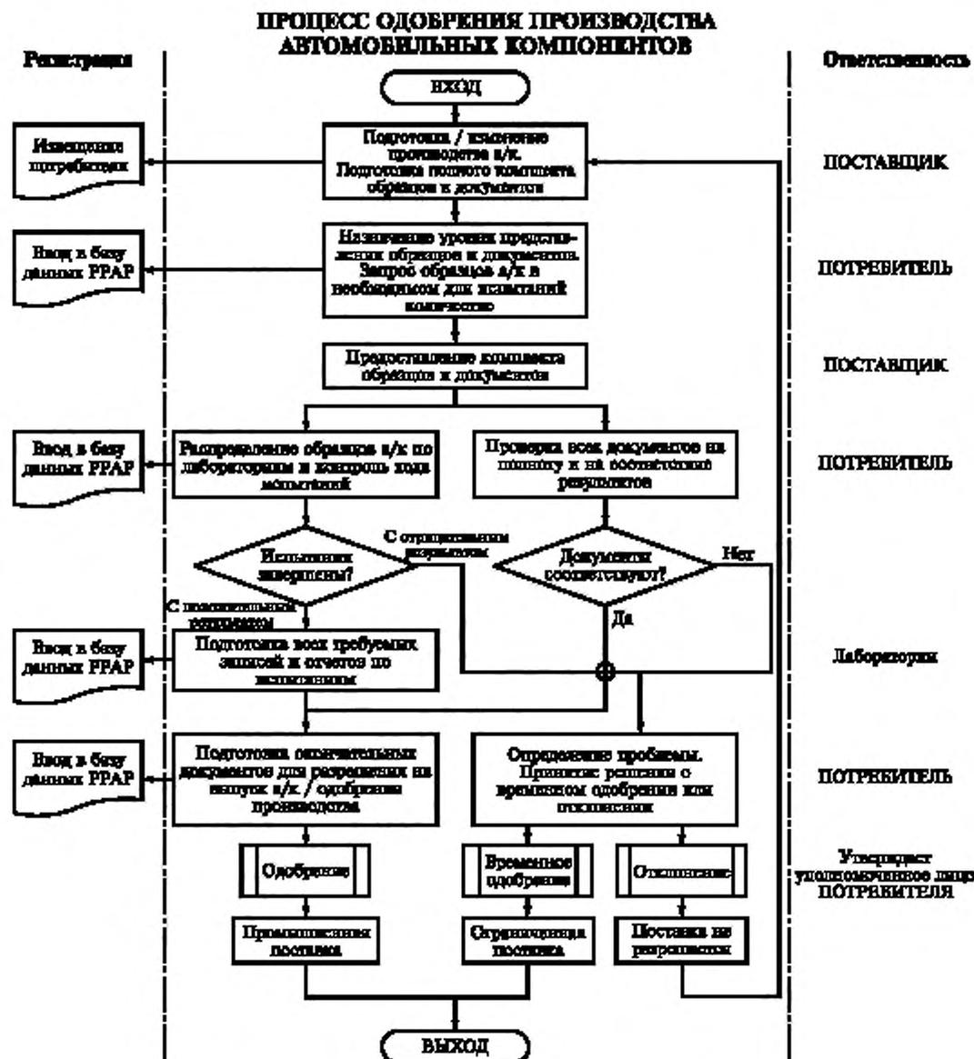
Рисунок 1 — Схема одобрения производства автомобильных компонентов
