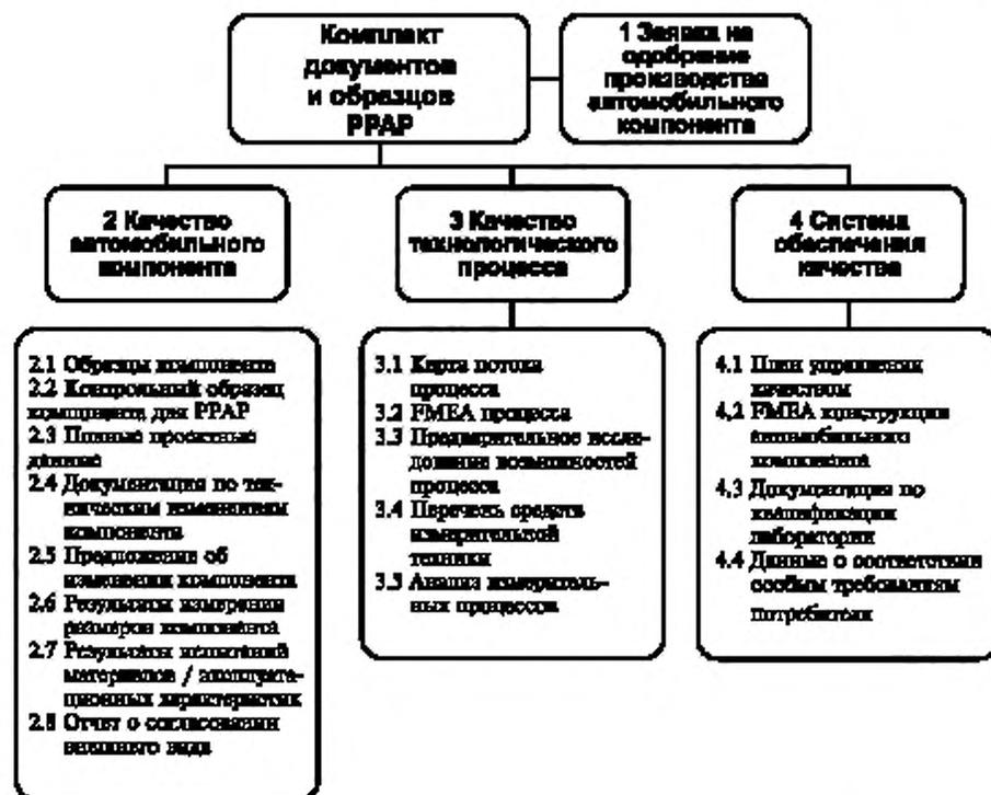
Рисунок 2 — Комплект документов и образцов для одобрения производства автомобильного компонента
