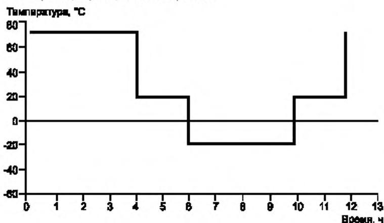
Рисунок 1 — График изменения температуры при испытаниях (один цикл)
