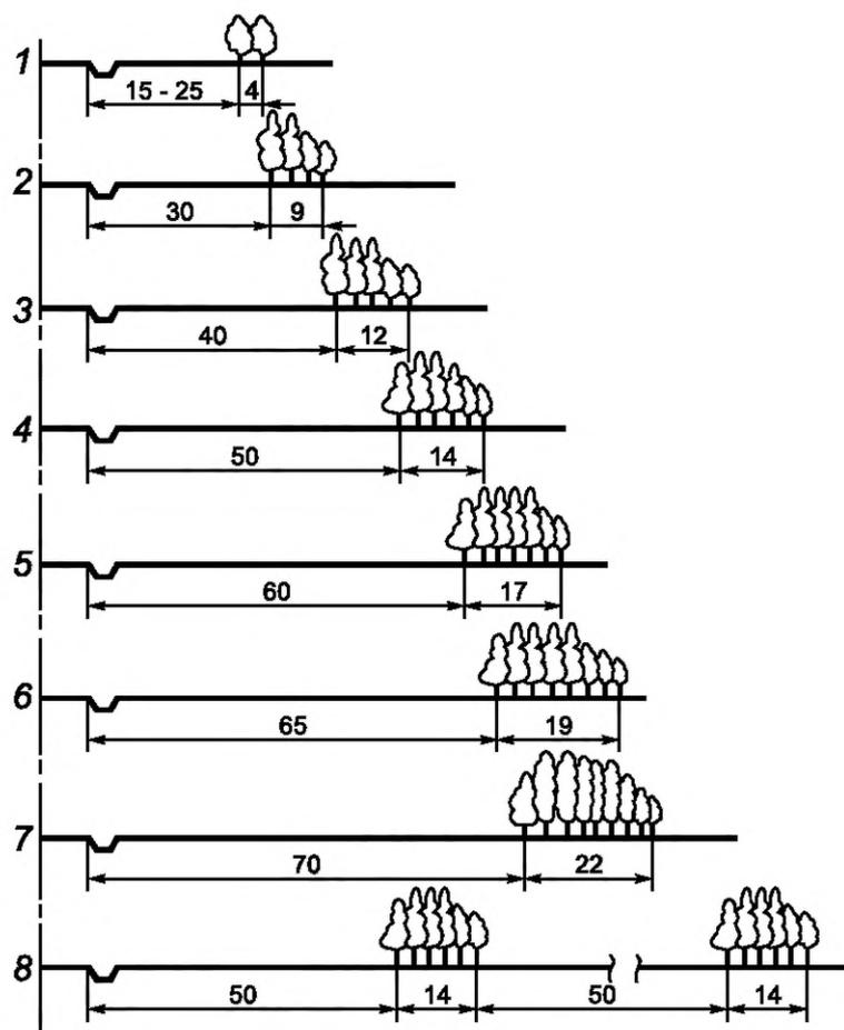
Объемы снегоприноса: 1 —  $25 \text{ м}^3/\text{м}$ ; 2 —  $50 \text{ м}^3/\text{м}$ ; 3 —  $75 \text{ м}^3/\text{м}$ ; 4 —  $100 \text{ м}^3/\text{м}$ ; 5 —  $125 \text{ м}^3/\text{м}$ ; 6 —  $150 \text{ м}^3/\text{м}$ ; 7 —  $200 \text{ м}^3/\text{м}$ ; 8 —  $250 \text{ м}^3/\text{м}$
