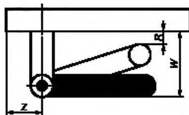
$R$  — минимальное расстояние между ручкой в нажатом состоянии и поверхностью полотна дверного блока;  $W$  — максимальный размер устройства (в плане);  $Z$  — минимальное расстояние до края полотна дверного блока
