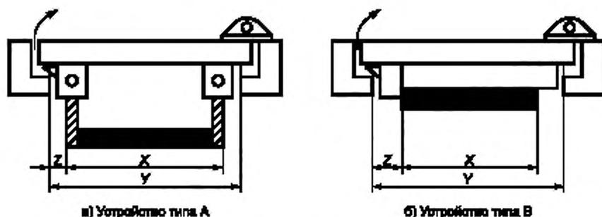
X — оптимальная длина штанги; Y — ширина полотна дверного блока в закрытом положении; Z — расстояние от штанги до коробки дверного блока
