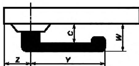
$C$  — минимальное расстояние между ручкой и поверхностью полотна дверного блока;  $W$  — максимальный размер устройства (в плане);  $Y$  — минимальная длина ручки;  $Z$  — минимальное расстояние до края полотна дверного блока
