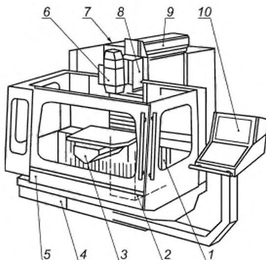
1 — стойка станка и привод подачи, ось Y; 2 — поперечный суппорт с вертикальным столом и приводом подачи, ось X; 3 — рабочий стол — неподвижный или вращающийся; 4 — система подачи СОЖ, система охлаждения; 5 — кабина; 6 — фрезерная головка с вертикальным шпинделем; 7 — электрический шкаф; 8 — фрезерная головка с горизонтальным шпинделем и приводом подачи, ось Z; 9 — главный привод; 10 — пульт управления
