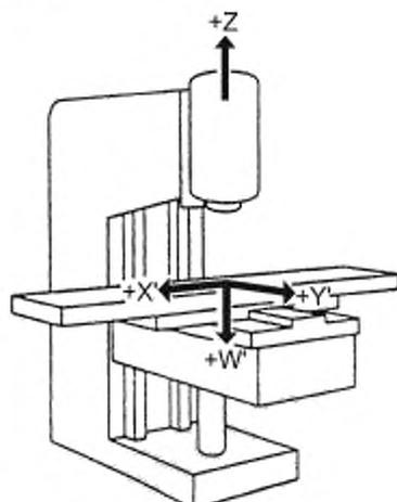
Рисунок С.2 — Консольно-фрезерный станок с вертикальным шпинделем
