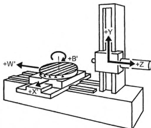
Рисунок С.7 — Фрезерно-расточный станок с горизонтальным шпинделем
