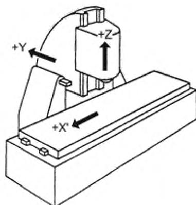
Рисунок С.3 — Бесконсольно-фрезерный станок с вертикальным шпинделем
