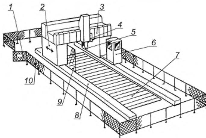
1 — доступ с блокировкой; 2 — перемещаемые стойки; 3 — телескопические стальные щитки; 4 — дополнительный пульт управления; 5 — фреза; 6 — рабочая станция, закрытая с трех сторон. Перемещение со стойками; 7 — стол станка; 8 — крышки над направляющими (станка); 9 — ограждение мигящего типа; 10 — ограждение по периметру (забор)
