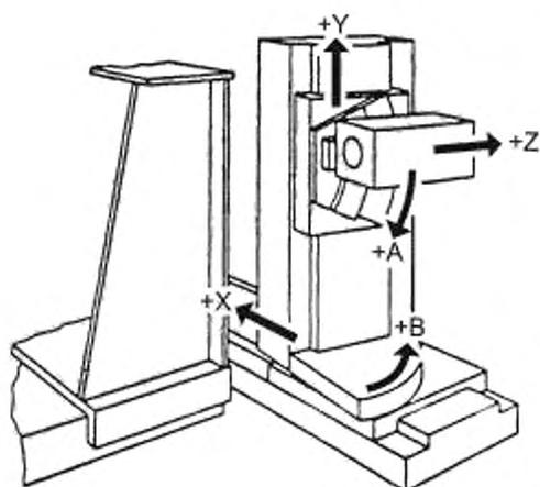
Рисунок С.6 — Копировально-фрезерный станок с горизонтальным шпинделем
