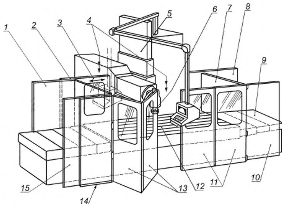
1, 8, 10, 15 — неподвижное ограждение, 2, 7 — перемещаемое ограждение, смонтированное на конце стола; 3 — заблокированное перемещаемое ограждение для доступа оператора; 4 — альтернативные положения оператора; 5, 9 — стальные телескопические крышки, 6 — фреза; 11, 13 — створчатые двери (блокированные); 12 — стол станка; 14 — положение створчатых дверей при загрузке стола
