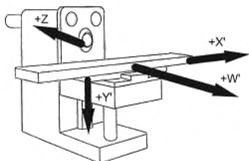
Рисунок С.1 — Консольно-фрезерный станок с горизонтальным шпинделем
