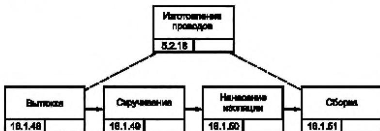
Рисунок В.6 — Процесс изготовления проводов изделия GT-350
