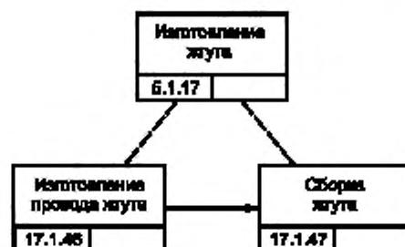
Рисунок В.4 — Процесс изготовления жгута изделия GT-350
