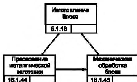
Рисунок В.3 — Процесс изготовления блока изделия GT-350
