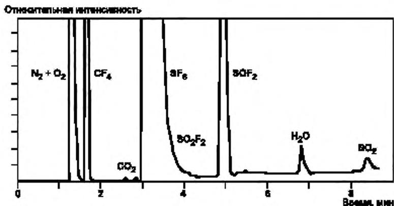
Рисунок В.3 — Типичная газовая хроматограмма при разложении элегаза
