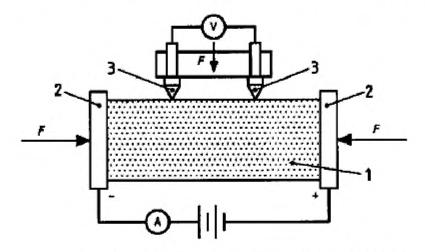
1 – образец для испытания; 2 – токоподводы;
