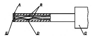
A — связывающее вещество; B — термопара из проволоки диаметром 0,3 мм типа K (хромоникалевый сплав) по IEC 807/02; C — ручное устройство, разрешающее контакт силой  $(4 \pm 1)$  H; D — поликарбонатная труба с внутренним диаметром 3 мм, наружным диаметром 5 мм; E — покрытый оловом медный диск диаметром 5 мм, толщиной 0,5 мм.
